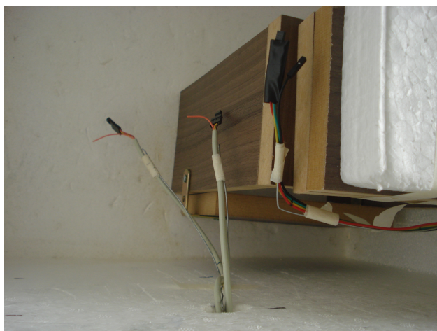
Figura 6.6: Detalhe do sensoreamento distribuído na caixa
