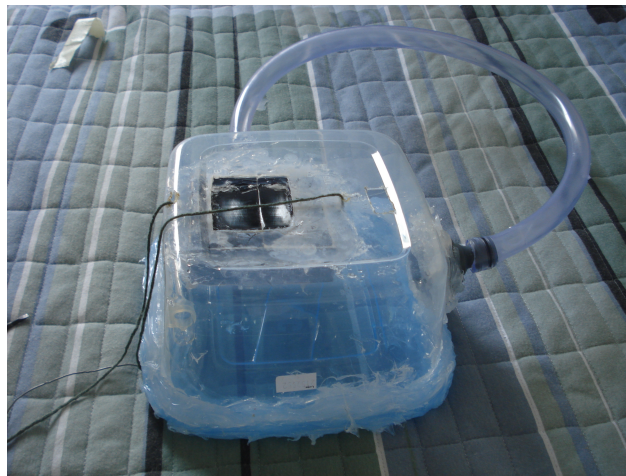
Figura 6.8: Reservatório de água e tubos
